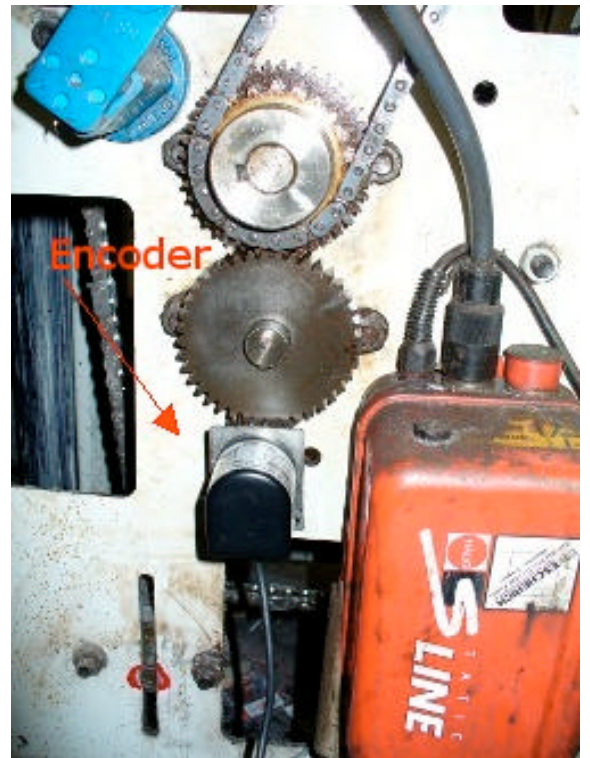
Esempio montaggio encoder su trasmissione modulo hot foil
