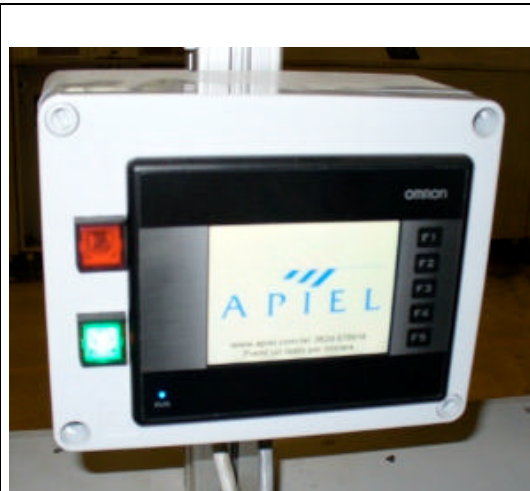
Pannello operatore comando
