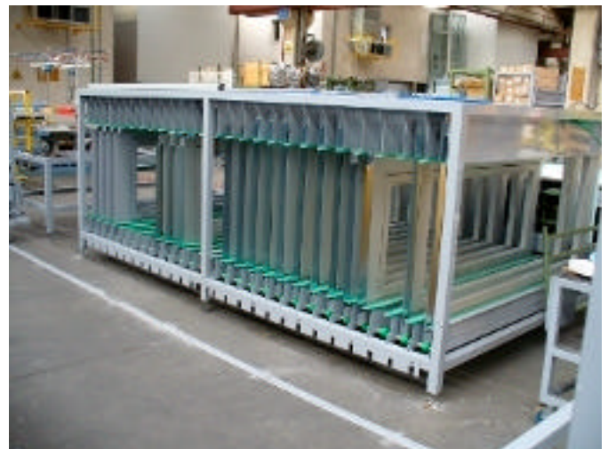
Magazzino telai per porte
