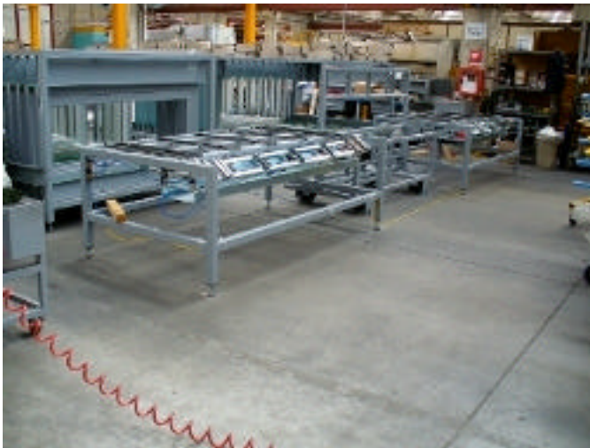
Banchi montaggio telai per porte
