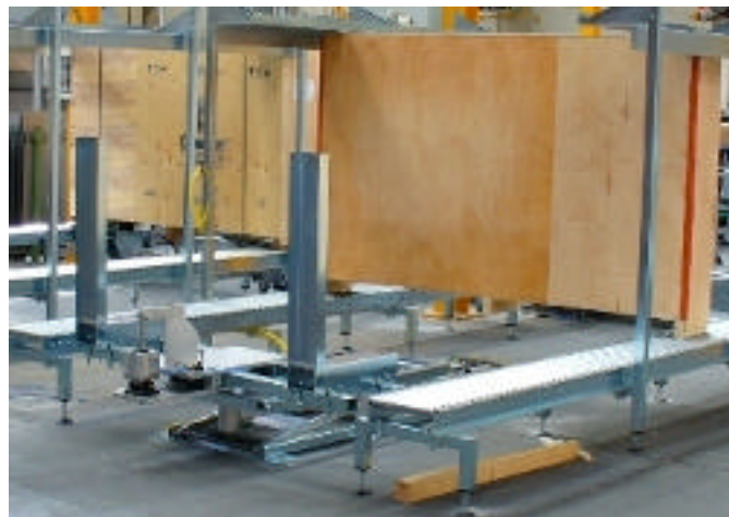
Magazzino casse vuote e banco montaggio casse
